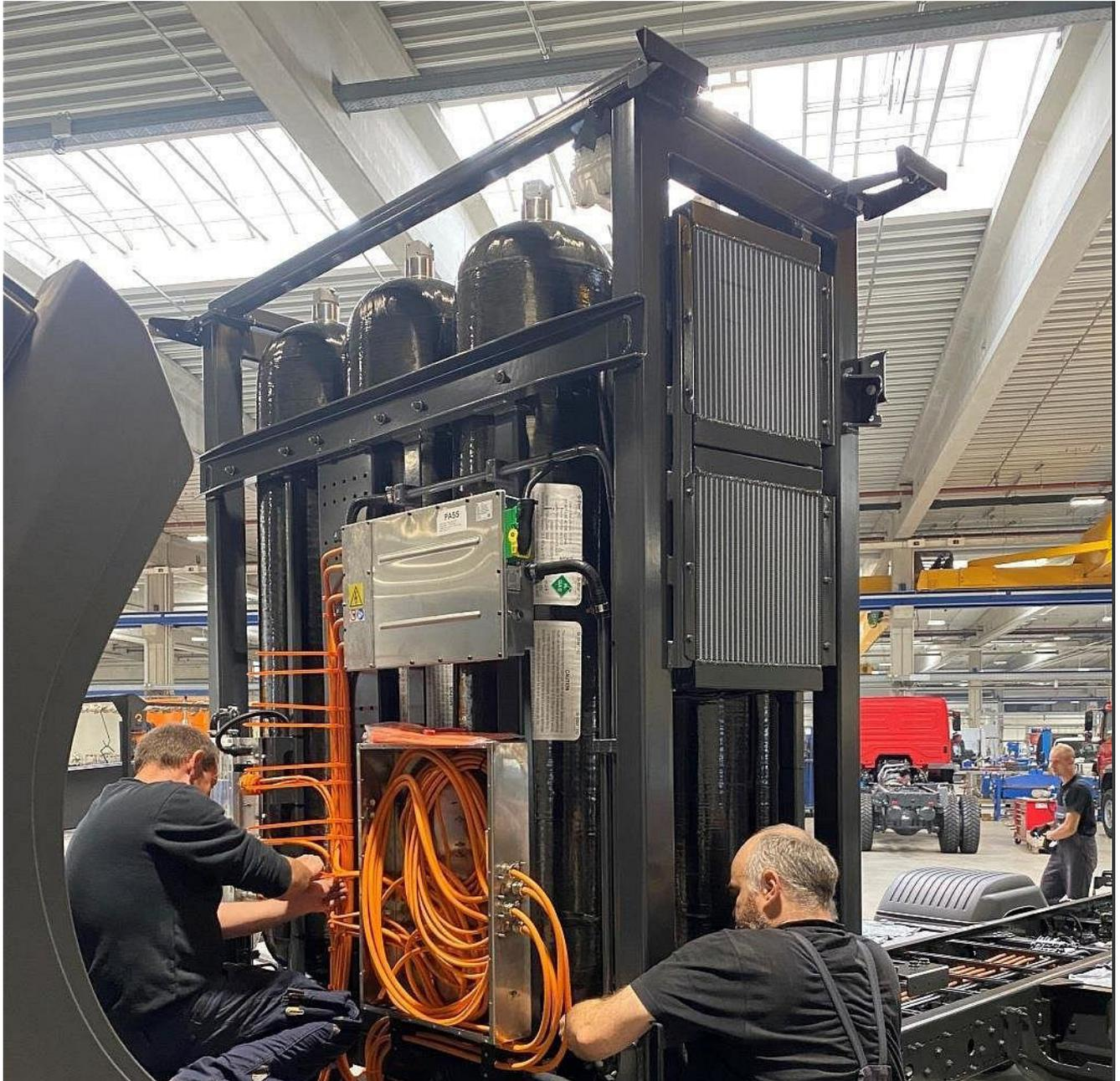
Hinter der Fahrerkabine befinden sich sechs Wasserstoff-Tanks.
