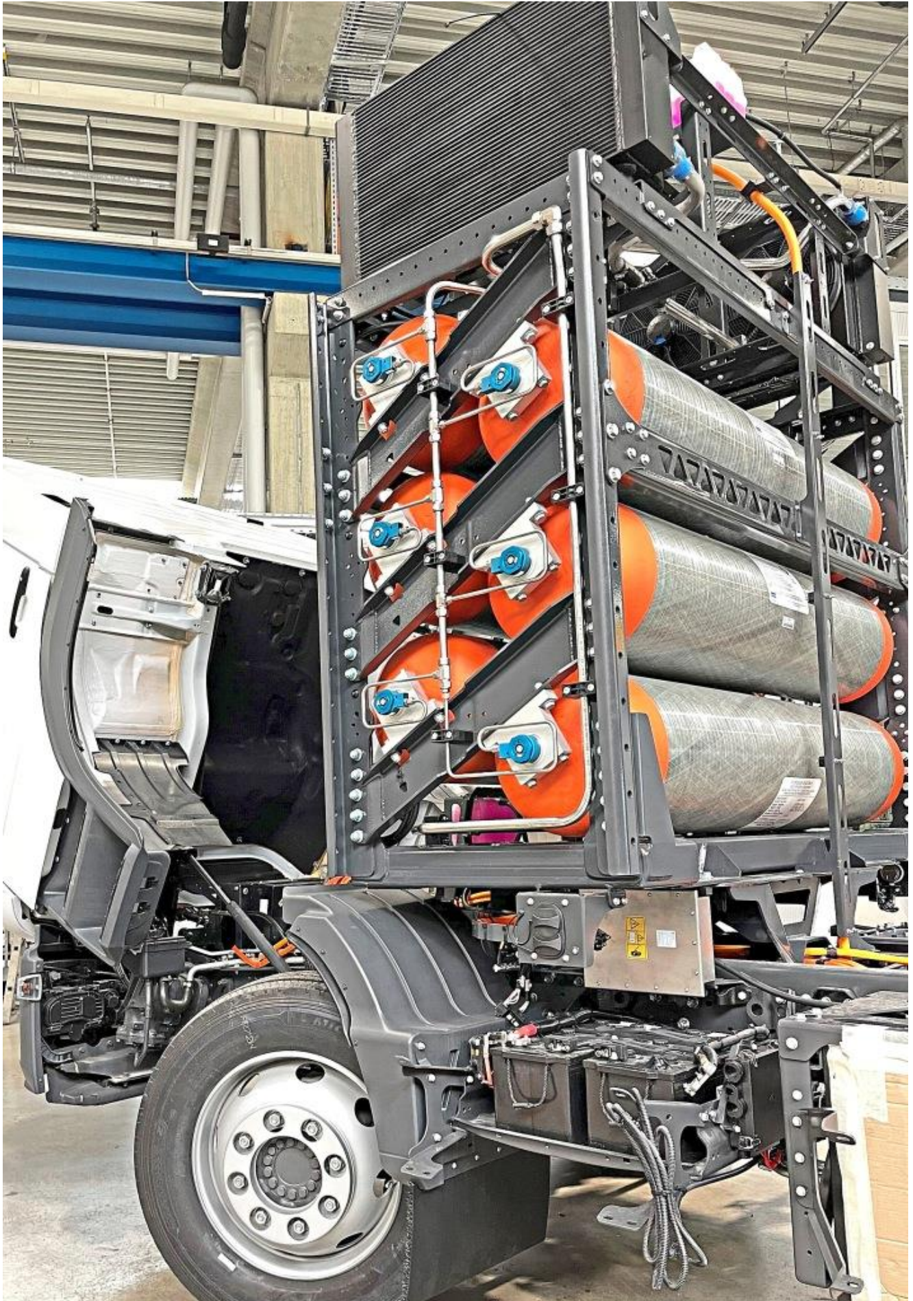
Der Wasserstoff-Tank: Sechs Flaschen fassen 30 Kilogramm. Das
